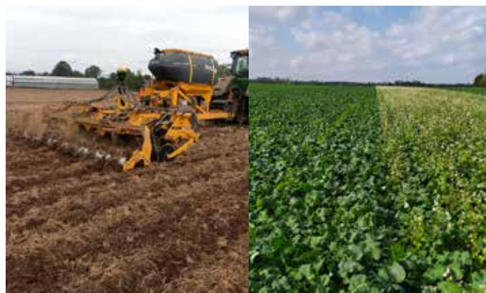
Obr. 10: Zonální uložení hnojiva do hloubky 35 cm před výsevem ozimé řepky strojem Bednar TerraStrip. (foto: J. Šmöger)
