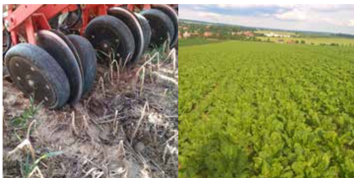
Obr. 5: Přímé setí cukrové řepy do vymrzlé hořčice secím strojem kverneland monopill s přípravou do mulče (foto: J. Slabý)
