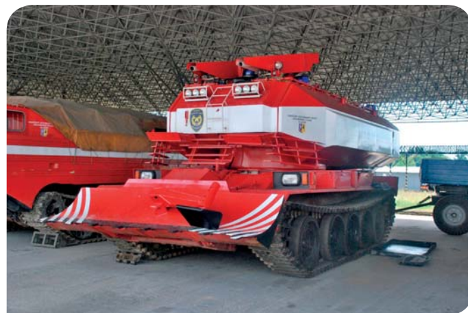
Požární tank SPOT 55 určený k likvidaci rozsáhlých lesních požárů.
