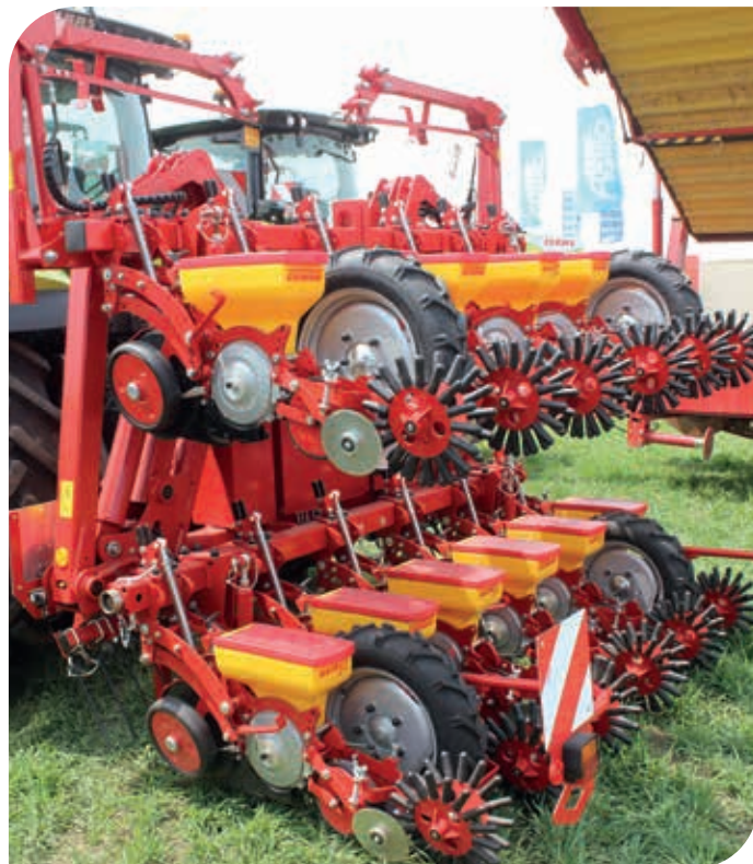
Přesné secí stroje Matrix mají novinku, rozšíření o variantu s hydraulickou podporou tlaku (otevřít nové možnosti v regulaci přitlačku na výsevní jednotky) a značením kolejových řádků
