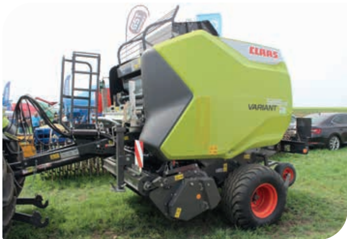
Provedení lisů Variant 565 RC a 585 RC s pohonem heavy-duty a sedmnáctinožovým řezacím ústrojím je určeno k profesionálnímu využívání a pro případ, kdy převažuje sklizeň zavadlé hmoty
